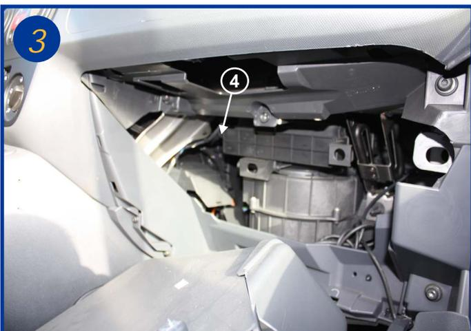
Ouvrir le boîtier filtrant, la fermeture du couvercle se trouve sur la gauche (4). Retirer le couvercle.
