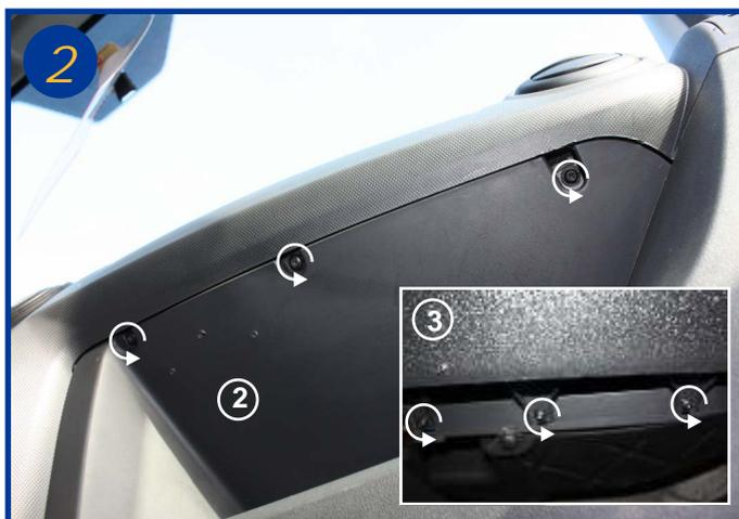
Dévisser les 3 vis torx T30 à l'intérieur de la boîte à gants dans sa partie supérieure (2) puis les 4 vis Torx T30 situées dessous (voir encadré). Tirer assez fort sur l'ensemble afin de la sortir totalement (6 agrafes la maintienne en place).
