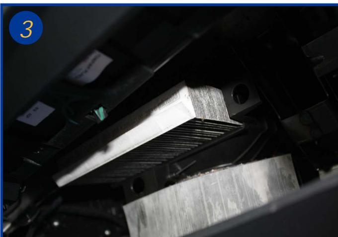
Extraire le filtre usagé de son logement et le remplacer. Aucun outil n'est nécessaire pour cette action.
