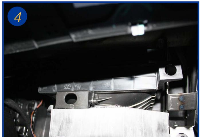
Une fois le nouveau filtre remis en place, refermer le couvercle du boîtier filtrant en le positionnant par la droite tout d'abord et en le cliquetant ensuite à gauche. Fermer la boîte à gants.
