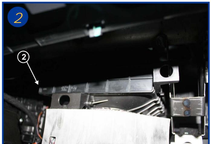
Ouvrir le boîtier filtrant par la gauche, une patte est prévue à cet effet (2) et retirer le couvercle.
