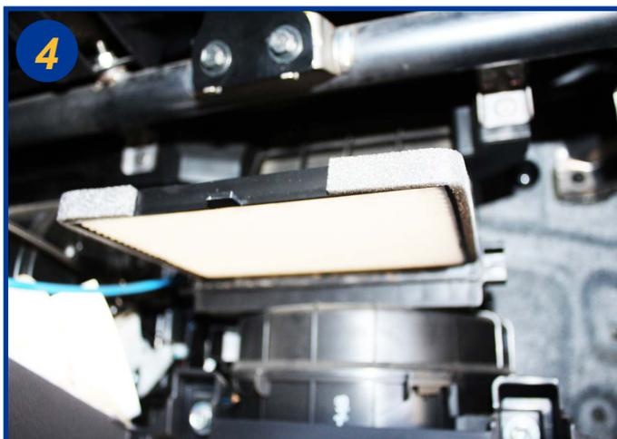
Sortir l'élément filtrant usagé et le remplacer. Le remontage s'effectue dans l'ordre inverse du démontage.
