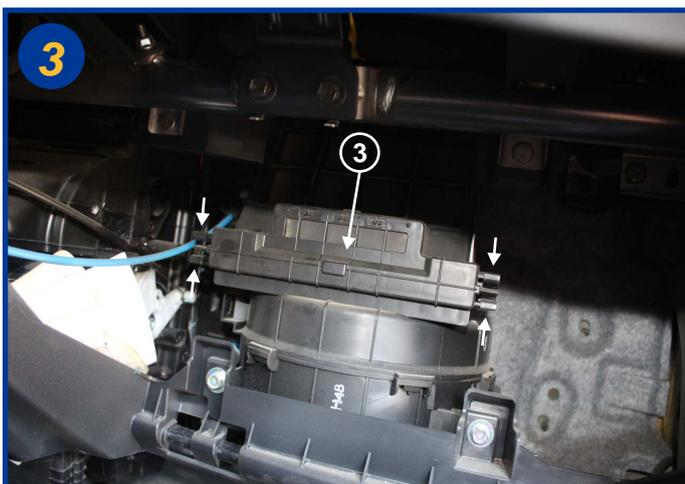
De part et d'autre du couvercle (3) appuyer sur les deux fermetures dans le sens des flèches pour ouvrir le boîtier filtrant.
