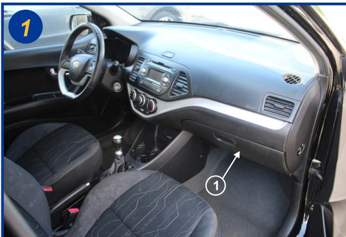
Le filtre d'habitacle est situé à l'intérieur du véhicule, côté passager derrière la boîte à gants (1). Ouvrir la boîte à gants.
