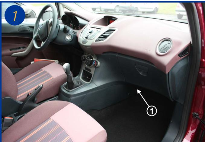
Le filtre d'habitacle est situé à l'intérieur du véhicule, côté passager derrière la console centrale (1).
