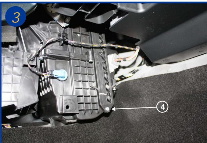
Le couvercle du boîtier filtrant est maintenu par 1 vis à sa partie inférieure (4). Dévisser cette vis Torx T25 et retirer le couvercle.
