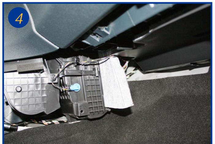
Extraire l'élément filtrant usagé en déformant . Le remontage s'effectue dans l'ordre inverse du démontage.
