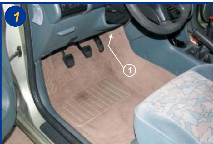
Les filtres d'habitacle sont situés à l'intérieur du véhicule côté conducteur, à côté de la pédale d'accélérateur (1).
