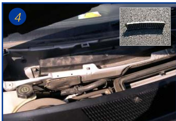
Engager les 2 languettes de l'élément filtrant sous les nervures du cadre en pliant légèrement l'élément pour l'adapter à la courbure. Clipser les agrafes des 2 cotés dans les ergots de blocage du cadre. Le remontage s'effectue dans l'ordre inverse du démontage.
