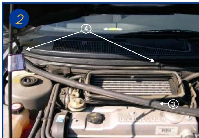
Oter le joint d'étanchéité entre le compartiment moteur et le conduit d'aération (3). Dévisser les 2 vis torx situées sur la demi-grille droite (4). Pour ces opérations, il vous est nécessaire d'utiliser un tournevis torx type n°30.
