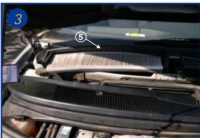
Ecarter au centre les 2 moitiés de la grille d'aération. Retirer la moitié droite de cette grille. Faire basculer les 2 pattes d'encliquetage (coté droit et coté gauche) sur le cadre porte-filtre (5). Dégager par le haut le cadre porte-filtre afin de retirer l'élément filtrant usagé.
