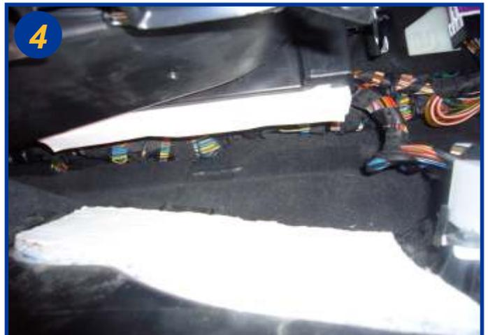
Le couvercle du boîtier filtrant se coulisser vers la droite pour pouvoir se retirer. Extraire le filtre usagé vers le bas et le remplacer. Le remontage s'effectue dans l'ordre inverse du démontage.
