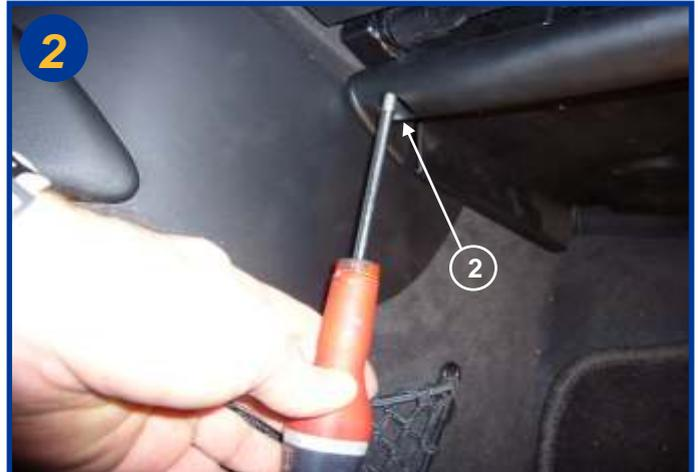
Se munir d'un tournevis cruciforme et dévisser sous la boîte à gants côté console la vis (2).
