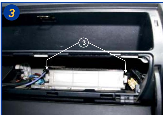
Retirer le couvercle du boîtier filtrant en agissant sur les 2 fermoirs (3) à chaque extrémité. Extraire l'élément filtrant usagé et le remplacer. Le remontage s'effectue dans l'ordre inverse du démontage.
