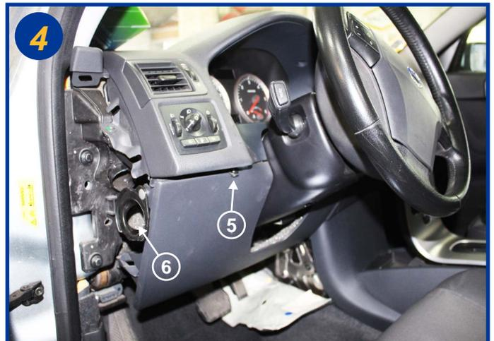
Dévisser la vis torx T25 (5) devant le tableau de bord, puis déconnecter la bouche de ventilation (6). Vous pouvez maintenant extraire le carter complet en débranchant auparavant la veilleuse du dessous.
