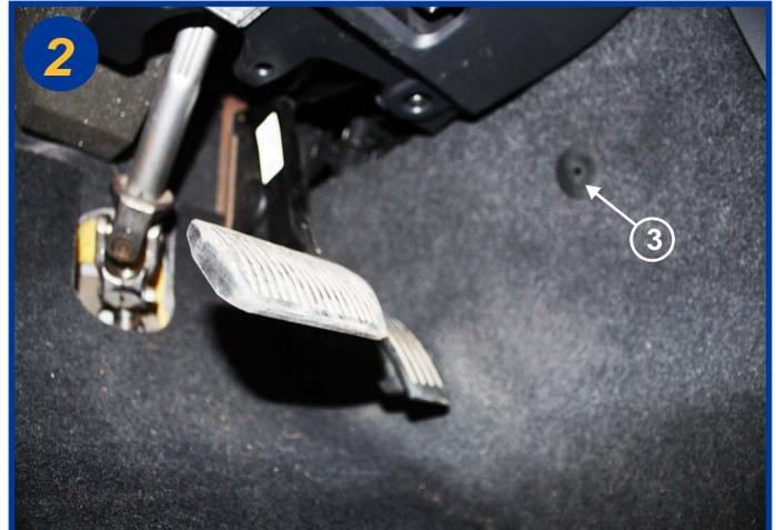
A l'aide d'un tournevis plat retire le clips plastique (3). Replier ensuite la moquette pour la placer sous les pédales.
