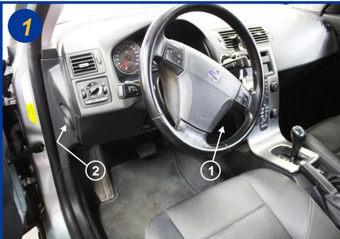
Le filtre d'habitacle est situé à l'intérieur du véhicule, côté conducteur à côté de la pédale d'accélérateur (1). Dégrafer le carter (2) en tirant fortement. Retirer ce carter.
