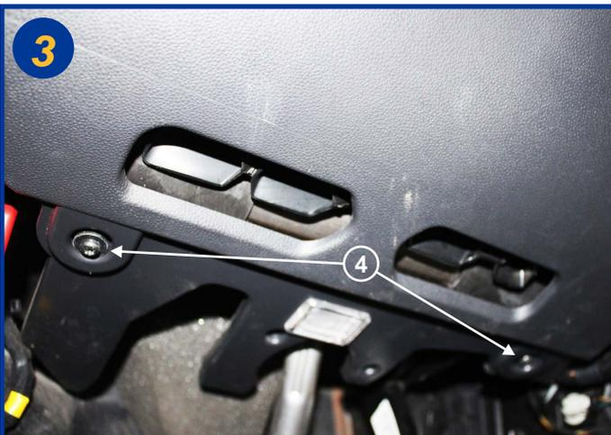
Dévisser les 2 vis torx T25 (4) sous la colonne de direction.
