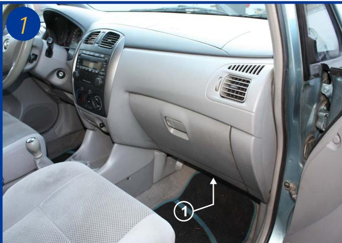
Les filtres d'habitacle sont situés à l'intérieur du véhicule côté passager sous la boîte à gants (1).
