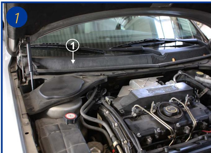
L'élément filtrant est situé sous le capot moteur, côté passager près de la baie de pare-brise (1).
