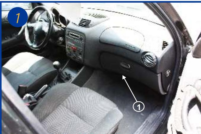
Les filtres habitacles sont situés à l'intérieur du véhicule, côté passager sous la boîte à gants (1).
