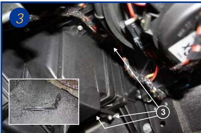
Dévisser les 3 vis de 5 du couvercle du boîtier filtrant (3) et le retirer (voir encadré).
