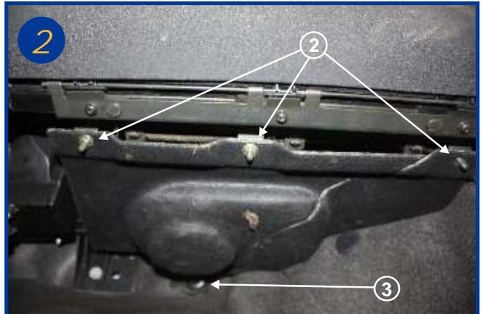
Dévisser les 3 vis de 10 (2) et la vis plastique (3) afin de retirer le carter souple sous la boîte à gants.
