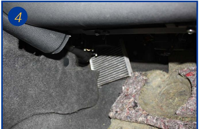
Extraire les 2 filtres usagés, ils sont placés l'un à côté de l'autre et les remplacer. Le remontage s'effectue dans l'ordre inverse du démontage.
