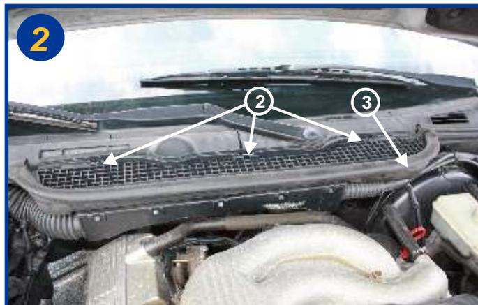
Retirer la grille de ventilation en actionnant les clips de fermeture (2). Retirer ensuite le joint (3).
