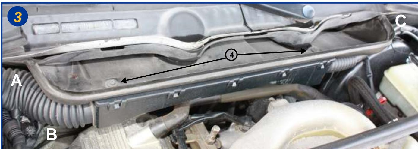
Dévisser les 2 vis cruciformes (4) puis dévisser les 3 vis hexagonale de 7mm situées en A, B et C. Extraire dans sa totalité le carter métallique.
