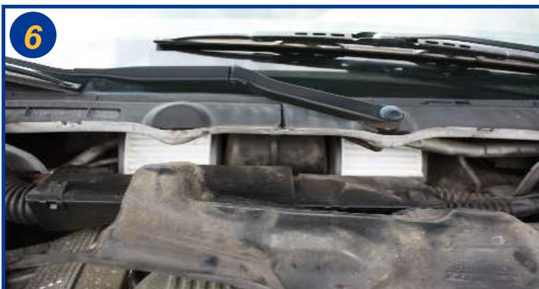
Placer 2 éléments filtrants neufs dans les logements. Remonter les différentes pièces préalablement démontés dans le sens inverse du démontage.
