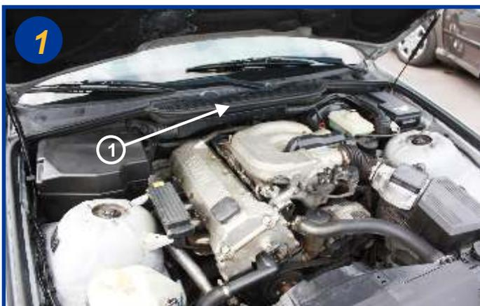
Les filtres d'habitacle sont situés sous le capot moteur, au centre (1) sous la grille de ventilation.
