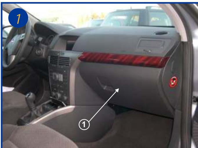
L'élément filtrant est situé dans l'habitacle du véhicule côté passager derrière la boîte à gants. (Flèche 1).
