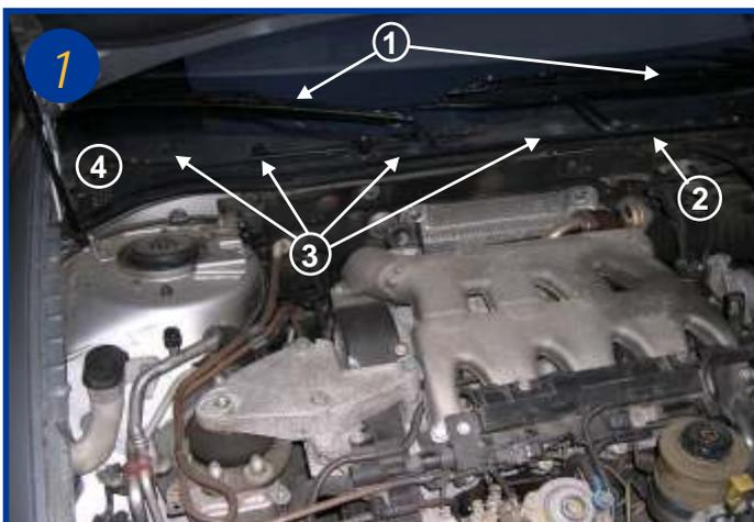
L'élément filtrant est situé sous le capot moteur sur la baie du pare brise côté passager. Démontez les deux balais d'essuie-glaces (flèche 1) puis le joint d'étanchéité du compartiment moteur (flèche 2). Dévissez ensuite d'un quart de tour les 8 vis plastique (flèches 3) situées sur la grille d'aération (4) et la retirer.
