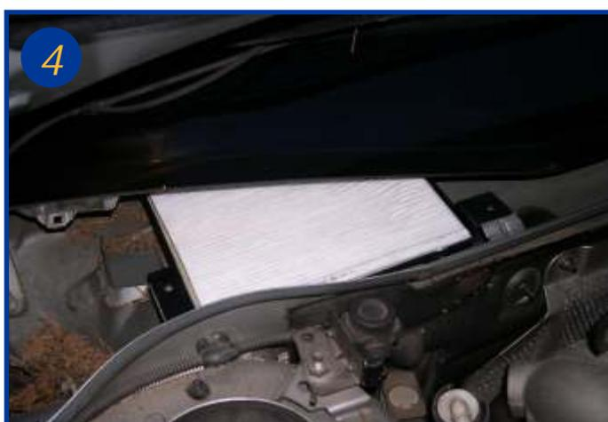
Replacer un nouvel élément en veillant à ce les ergots soient bien remis en place. Le remontage s'effectue dans l'ordre inverse du démontage.
