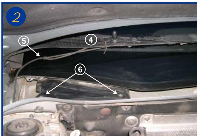
Placer la grille d'aération (4) sur le pare brise. Dans certains cas il n'est pas nécessaire de démonter le tuyau d'arrivée d'eau du lave glace (5). Dévissez ensuite le capot protecteur de l'élément filtrant (flèches 6). Les véhicules qui sont équipés d'origine ne possèdent pas de capot.
