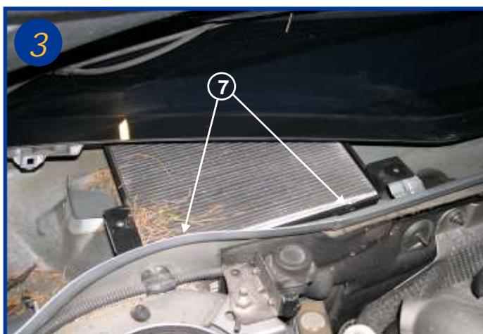
Extraire l'élément filtrant de son boîtier en pressant sur le filtre afin de le dégager des ergots de maintien (flèche 7). Retirer l'élément filtrant usagé et nettoyer éventuellement les abords du boîtier.
