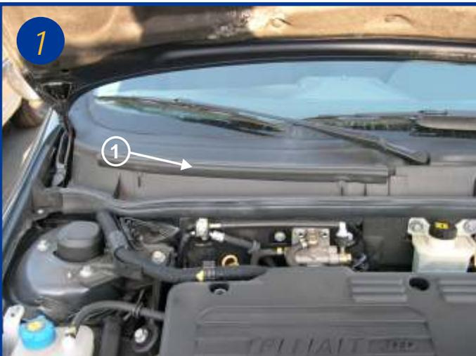
L'élément filtrant est situé sous la baie du pare brise du côté passager. Ouvrir le capot moteur et localiser le boîtier du filtre.
