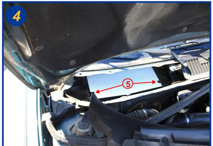
Soulever les 2 pattes de fermeture (5), extraire le filtre usagé et procéder à son remplacement. Le remontage s'effectue dans l'ordre inverse du démontage.
