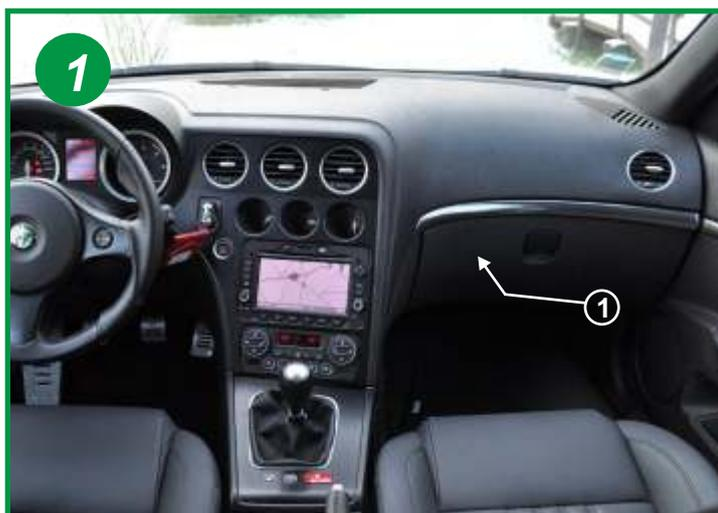
Le filtre d'habitacle est situé à l'intérieur du véhicule, coté passager et accessible à l'intérieur de la boîte à gants (1).
