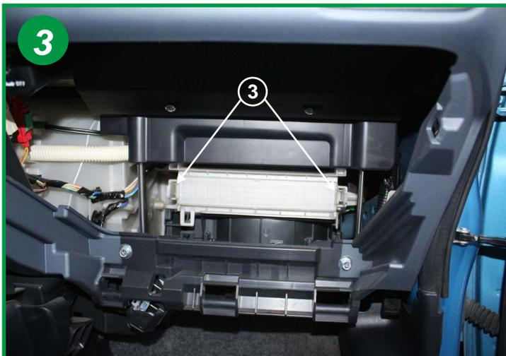
L'accès au boîtier filtrant est alors possible, actionner les 2 pattes de fermeture de part et d'autre du couvercle (3) et retirer celui-ci.
