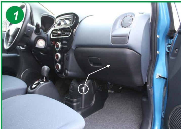
Le filtre d'habitacle est positionné à l'intérieur du véhicule coté passager derrière la boîte à gants (1). Ouvrir la boîte à gants.
