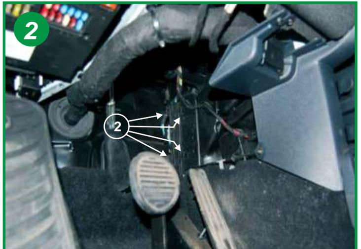
Ouvrir le boîtier filtrant en agissant sur les pattes plastiques de fermeture (2). Retirer le couvercle.
