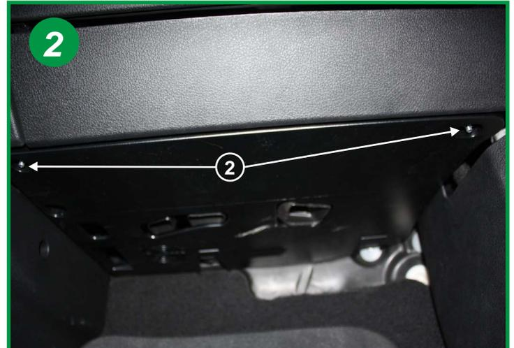
Sous la boîte à gants, dévisser les 2 écrous hexagonales de 8mm (2).
