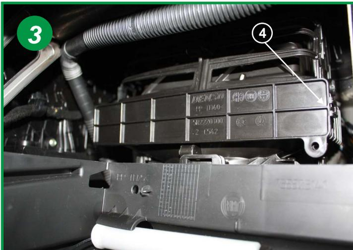
Ouvrir le boîtier filtrant en actionnant le fermoir situé sur la droite (4), le couvercle est articulé à gauche.
