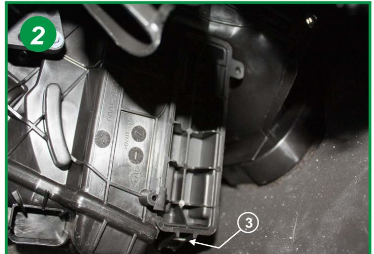
Ouvrir le boîtier filtrant par le dessous en écartant la patte de fermeture (3).
