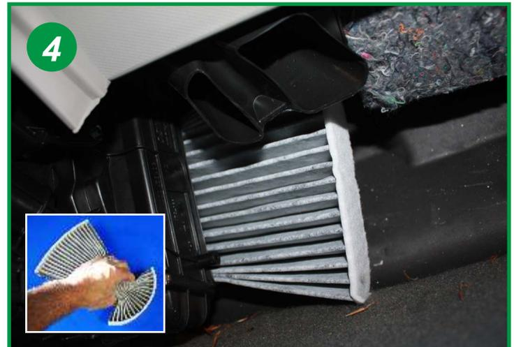
Le filtre de rechange est plissé horizontalement et il faut le déformer (voir encadré) pour le placer dans son logement. Le remontage s'effectue dans l'ordre inverse du démontage.
