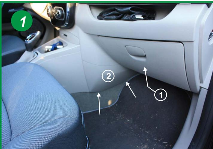
Le filtre d'habitacle est situé à l'intérieur du véhicule, côté passager sous la boîte à gants côté console centrale (1). Dégrafer le carter plastique (2) en partant de la base de celui-ci.
