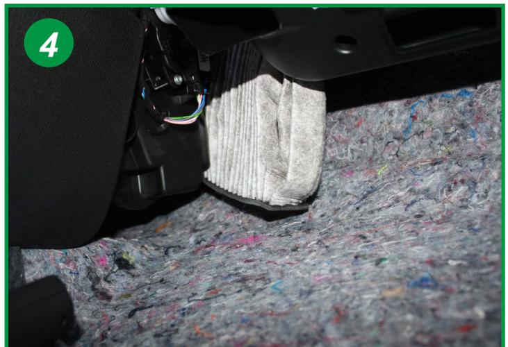
Pour le remontage du nouveau filtre, compresser les plis du nouveau filtre, puis placer la première partie de celui-ci pour qu'il se développe à l'intérieur. Replacer le couvercle du boîtier.
