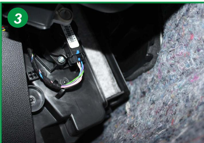
Détail du boîtier filtrant une fois ouvert. L'ouverture du boîtier filtrant est plus étroite que la largeur de l'élément filtrant, il est donc nécessaire de le déformer pour le sortir.
