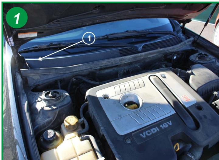
Le filtre d'habitacle est situé sous le capot moteur, coté passager sous la baie de pare-brise (1). Ouvrir le capot moteur.
