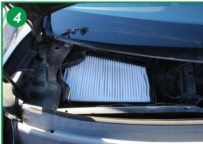
Extraire le filtre usagé et procéder à son remplacement. Nettoyer le boîtier filtrant avant de mettre le nouveau filtre. Le remontage s'effectue dans l'ordre inverse du démontage.
