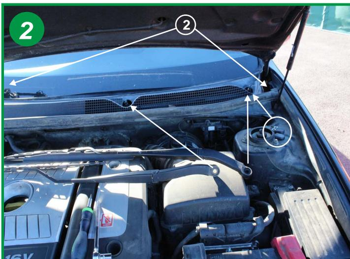
Retirer les essuies-glace: pour cela retirer à l'aide d'un tournevis plat les caches puis les écrous de 14 mm. Retirer ensuite, de chaque côté (2) les goupilles en plastique.
