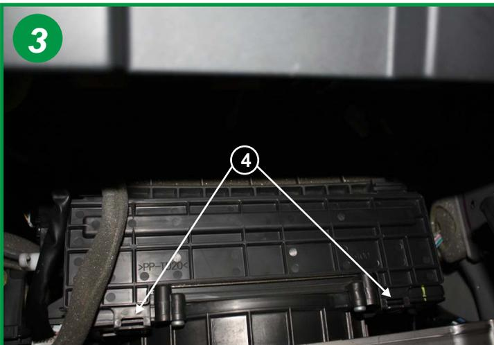
Ouvrir le boîtier filtrant en appuyant sur les 2 pattes plastique de fermeture (4) et retirer le couvercle.
