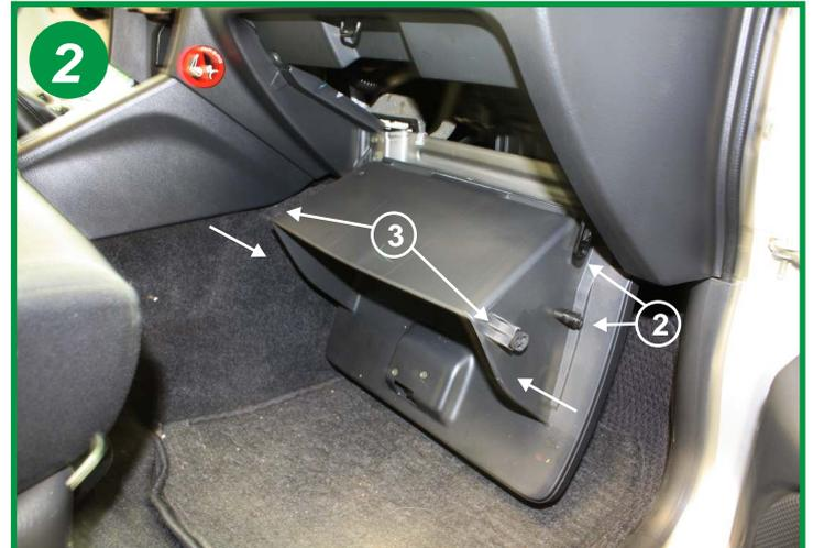
Dé-clipser l'amortisseur de retenue (2) puis presser sur les flancs de boîte à gants pour dégager les arrêteurs (3). Basculer la boîte à gants vers le bas.
