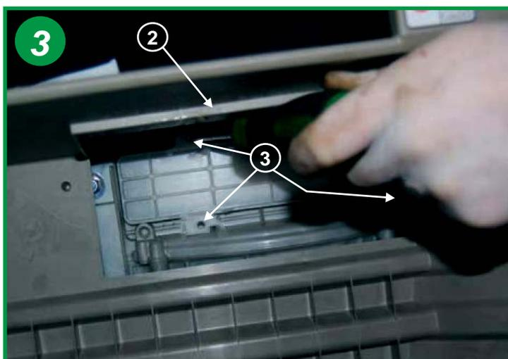
Ouvrir la trappe du boîtier filtrant (2), puis dévisser les 3 vis cruciformes du couvercle du filtre (3).
