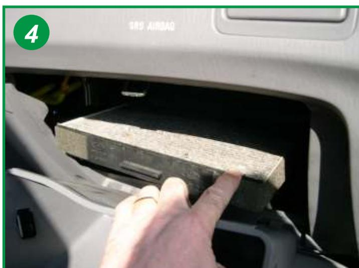
Sortir le filtre d'habitacle et le remplacer. Le remontage s'effectue dans l'ordre inverse du démontage. Aucun outil n'est nécessaire pour cette opération.
