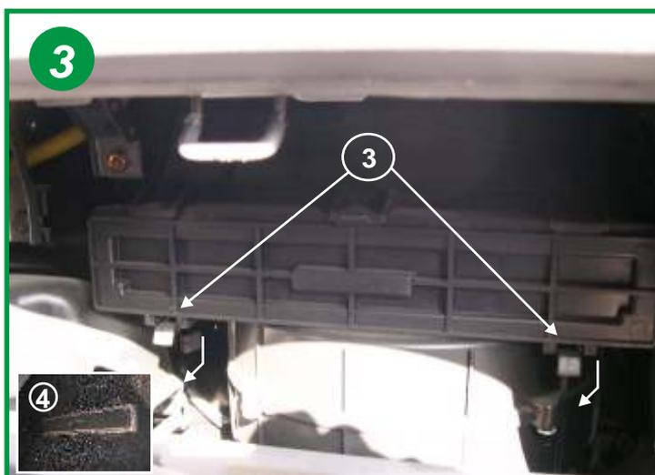
Le boîtier est alors visible, agir sur les deux clapets de fermeture (repère 3), pour retirer la façade (repère 4)
