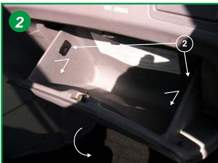
Ouvrir la boîte à gants, soulever et tirer les deux arrêteurs dans le sens des flèches (voir repère 2). Basculer la boîte à gants vers le bas.
