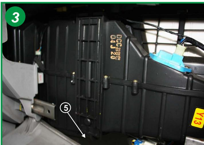
Ouvrir le couvercle du boîtier par le bas (5) en soulevant légèrement la patte de fermeture puis dégager les 2 pattes du haut pour le sortir.
