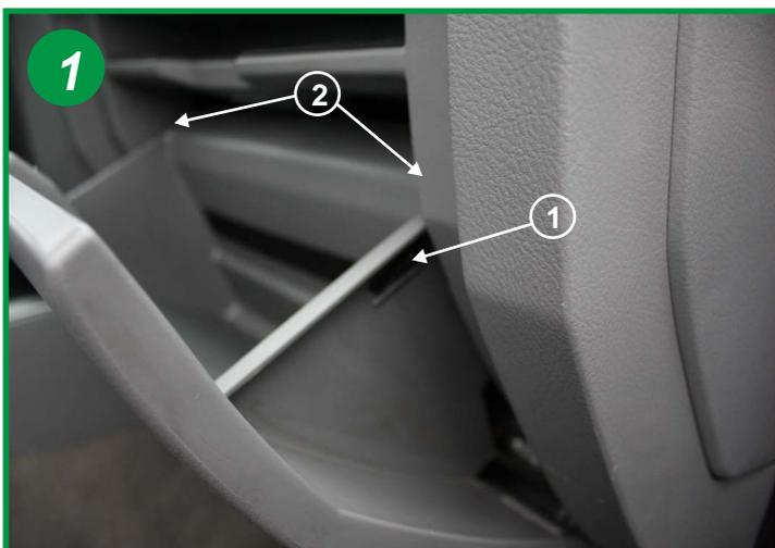
Le filtre d'habitacle est situé à l'intérieur du véhicule, coté passager derrière la boîte à gants. Ouvrir celle-ci et déconnecter l'élastique arrêteoir (1), puis appuyer sur les flancs pour dégager les butées (2).
