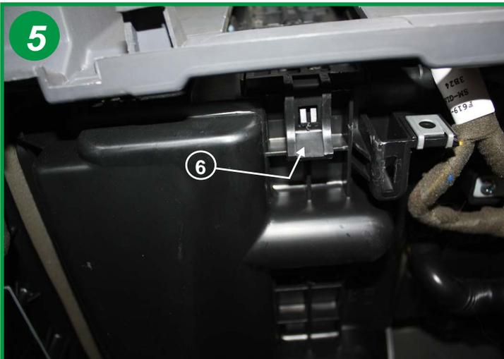
Tirez sur la patte de fermeture du boîtier filtrant (6) pour désengager le couvercle.
