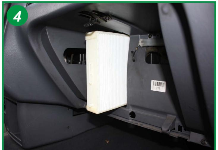
Procéder à son remplacement en mettant un élément neuf après avoir nettoyé le logement du filtre. Le remontage s'effectue dans le sens inverse du démontage.
