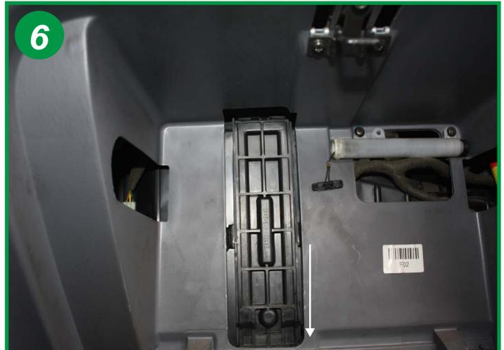
Faire descendre le couvercle dans le sens de la flèche et le retirer totalement.
