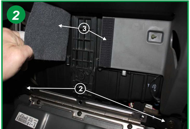
Dévisser les 2 vis de 10 de la traverse métallique et retirer le bloc tiroir de boîte à gants dans sa totalité (2). Le boîtier filtrant se trouve derrière une trappe souple fermée par un scratch (3).
