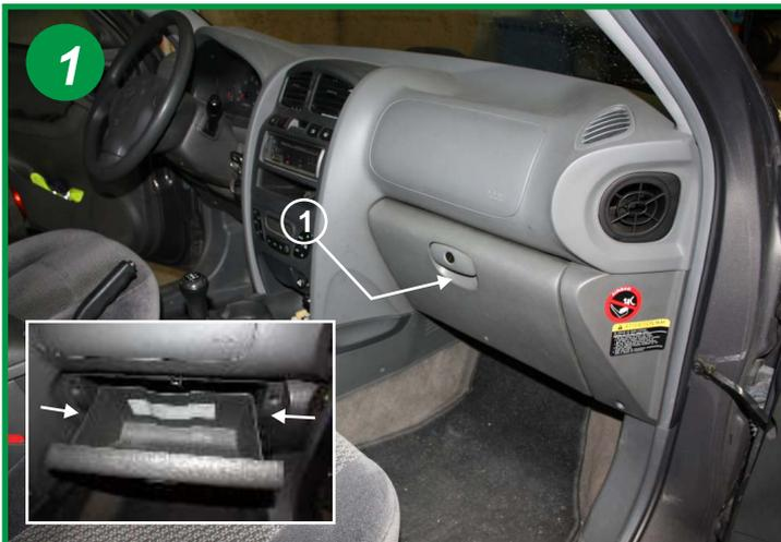
Le filtre d'habitacle est situé à l'intérieur du véhicule, coté passager derrière la boîte à gants (1). Ouvrir la boîte à gants, presser sur les flancs du tiroir (voir encadré) pour dégager les arrêtoirs et le basculer vers le bas.
