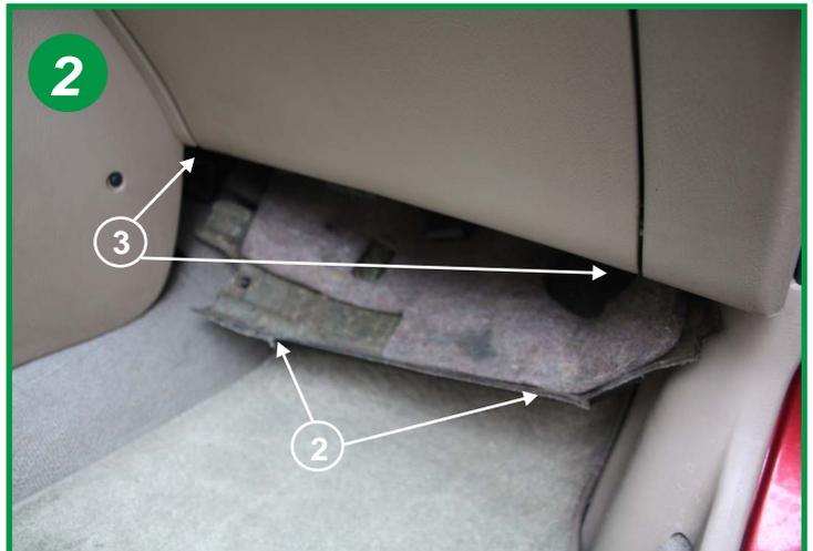
Retirer 2 clips plastique (2) et laisser tomber le carter souple, il n'est pas nécessaire de l'extraire totalement puis dévisser les 2 vis M6 de fixation de la boîte à gants (3) ouvrir celle-ci et la retirer.
