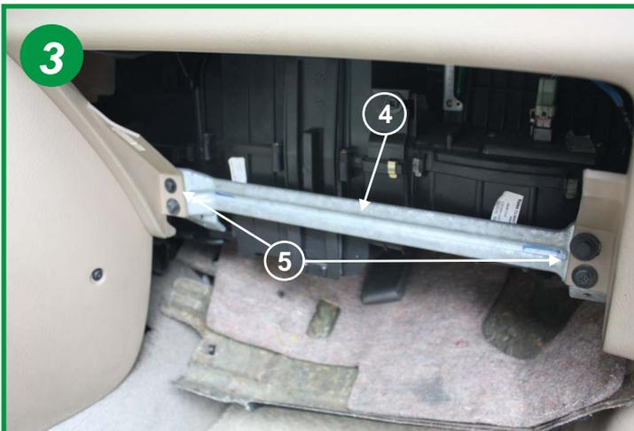
Retirer la barre de renfort (4) en dévissant 3 vis M6 et 1 vis M8 (5).
