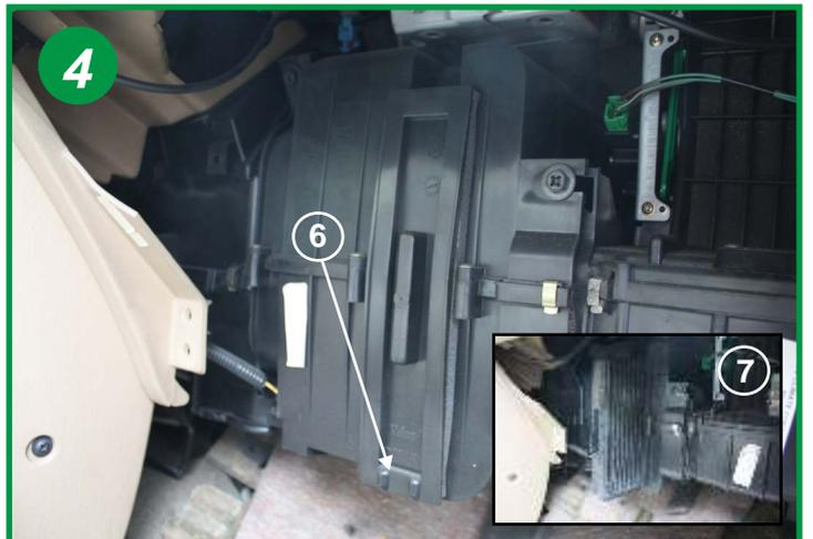
Retirer le couvercle du boîtier filtrant en déboîtant la patte inférieure (6).
