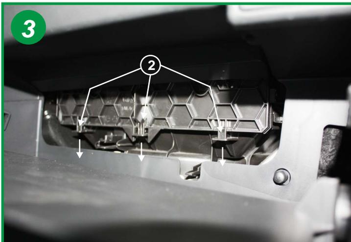
Ouvrir le boîtier filtrant en appuyant sur les 3 loquets (2) situés sur la partie inférieure du couvercle.
