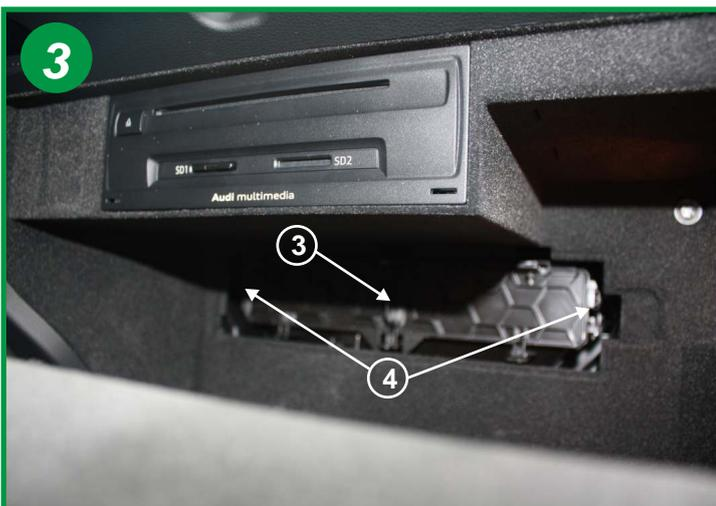
Retirer le couvercle du boîtier filtrant en tirant vers soi à l'aide de la poignée centrale (3) et en dégageant les loquets de fermeture (4) à gauche et à droite de la trappe.
