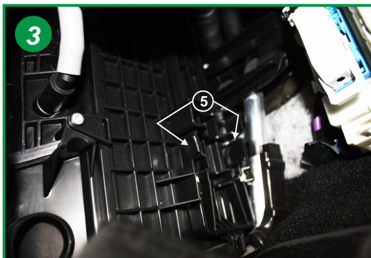
A l'aide des 2 poignées (5), retirer le couvercle du boîtier filtrant.
