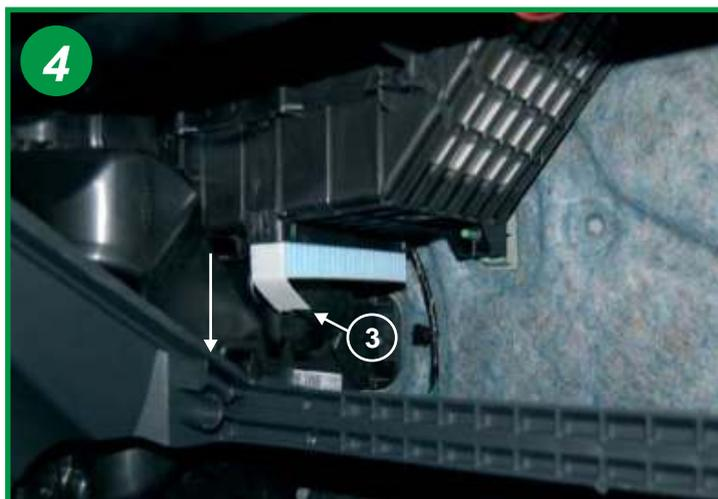
A l'aide de la languette (3), extraire l'élément vers le bas et le remplacer. Le remontage s'effectue dans l'ordre inverse du démontage.
