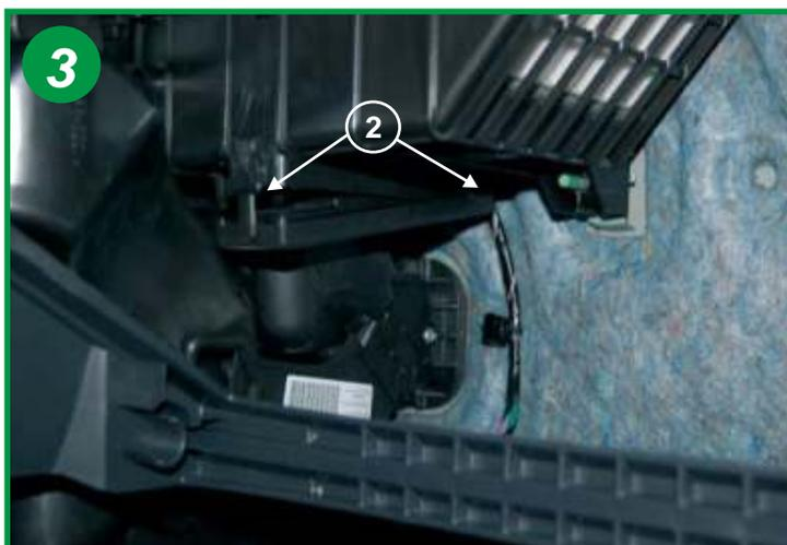
Agir sur les 2 fermoirs du boîtier filtrant (devant et derrière) (2) et extraire le couvercle du boîtier filtrant.
