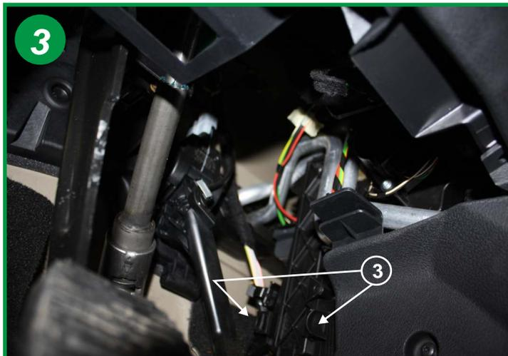
Presser sur les deux poignées prévues à cet effet pour retirer le couvercle du boîtier filtrant (3). Extraire l'élément filtrant usagé.
