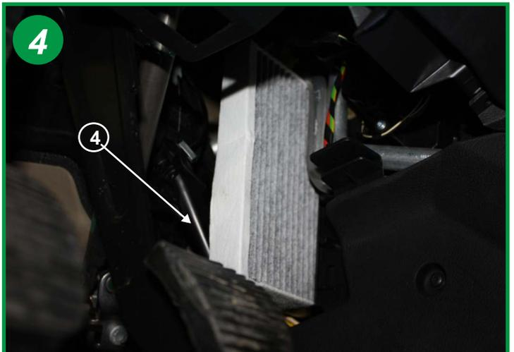
Procéder au remplacement de l'élément filtrant, afin d'avoir plus de facilité pour le mettre en place dans le boîtier, il est conseillé d'appuyer simultanément sur la pédale d'accélérateur (4). Le remontage s'effectue dans l'ordre inverse du démontage.
