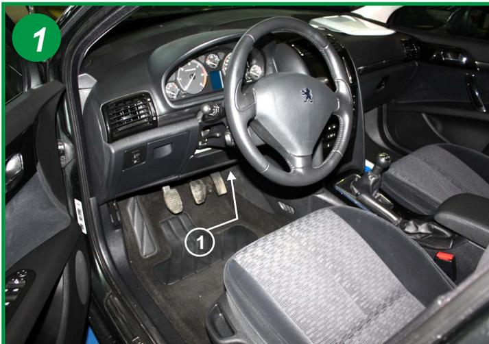
Le filtre d'habitacle est situé à l'intérieur du véhicule, côté conducteur à droite derrière la console centrale (1).
