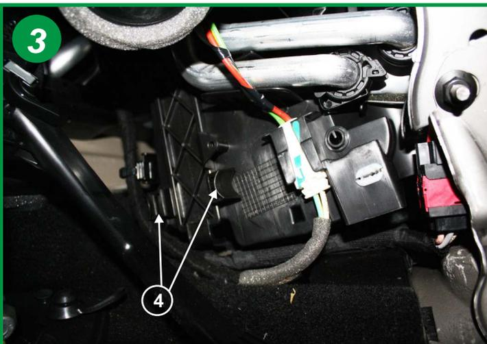
Exercer une pression sur les 2 pattes (4) et sortir le couvercle du boîtier filtrant.
