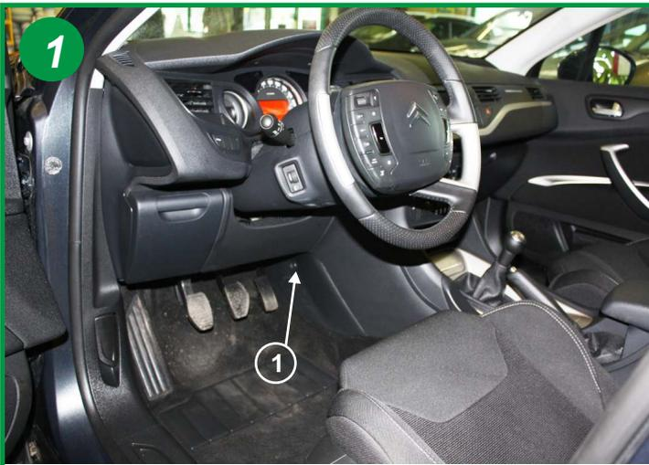
Le filtre d'habitacle est situé à l'intérieur du véhicule, côté conducteur, sous la colonne de direction côté console centrale (1).
