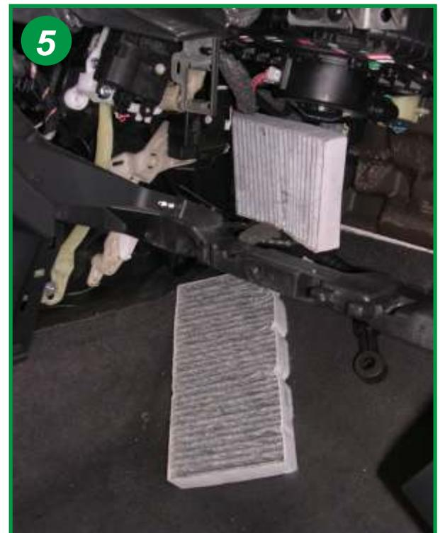
Les filtres sont au nombre de 2, ils sont placés l'un sur l'autre, les sortir et les remplacer.
