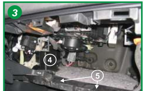
Déboîter la tubulure plastique (repère 4) en retirant le clips situé dessous puis le cache (repère 5) en retirant les 2 clips.
