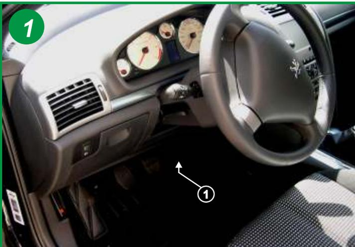
L'élément filtrant est situé sous la colonne de direction au dessus de la pédale d'accélérateur (voir flèche 1).
