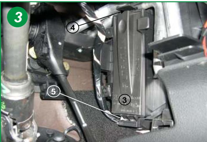
Localiser le couvercle du boîtier du climatiseur (3), soulever la patte de fermeture (flèche 4) et retirer le couvercle en le soulevant de son encoche (flèche 5).
