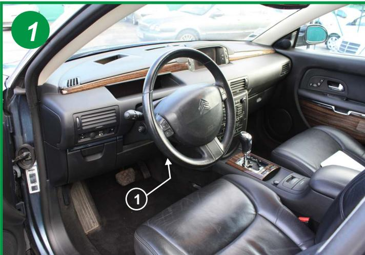
Le filtre d'habitacle est situé à l'intérieur du véhicule, coté conducteur, à coté de la colonne de direction coté console centrale (1).
