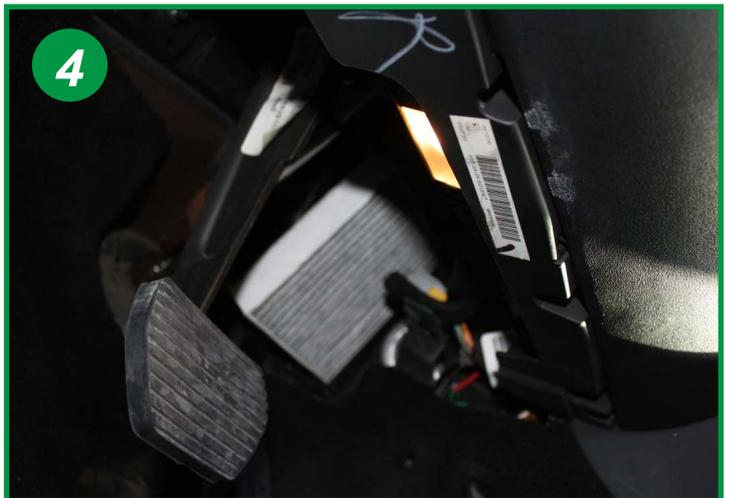
Appuyer sur la pédale d'accélérateur pour dégager le filtre usagé et procéder à son remplacement. Le remontage s'effectue dans l'ordre inverse du démontage.
