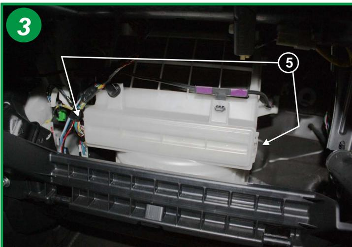
Ouvrir le boîtier filtrant en agissant sur les pattes de chaque côté du couvercle (5).
