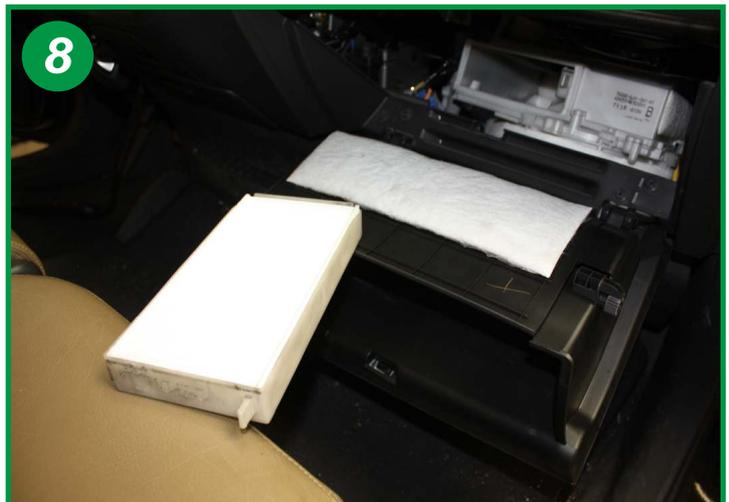
Replacer chaque cadre dans le boîtier. Le remontage s'effectue dans l'ordre inverse du démontage.
