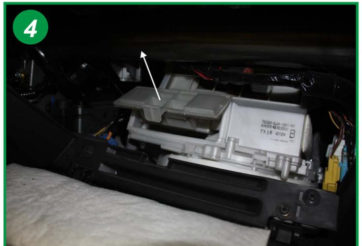
Retirer totalement la trappe d'ouverture en la soulevant (voir flèche).
