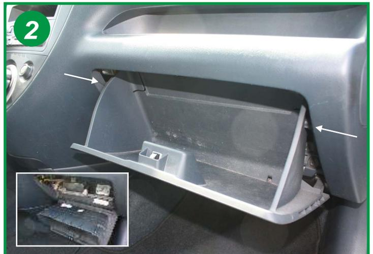
Presser sur les flancs du tiroir de boîte pour dégager les butées d'ouverture dans le sens des flèches et basculer le tiroir vers le bas (voir encadré).
