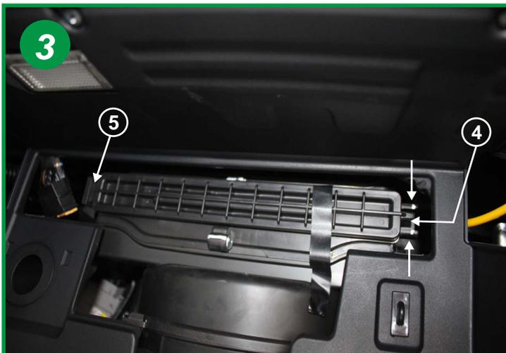
Ouvrir le boîtier filtrant en actionnant le fermetoir (4) à droite comme l'indiquent les flèches.
