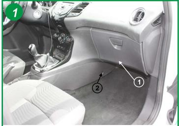
Le filtre d'habitacle est situé à l'intérieur du véhicule, coté passager sous la boîte à gants, coté console (1). Retirer le clips plastique (2).
