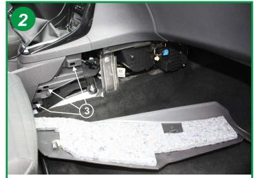
Sortir le flanc de la console centrale, il est agrafé dans sa partie gauche (3). il faut tirer assez fortement pour l'extraire.
