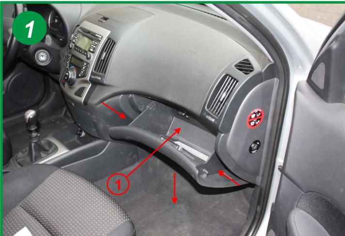
Le filtre d'habitacle est situé à l'intérieur du véhicule côté passager derrière la boîte à gants (1).
