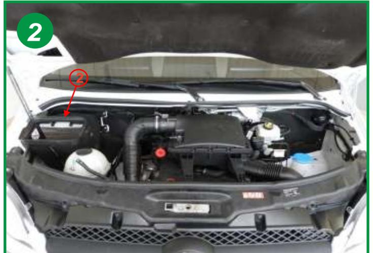
Ouvrir le capot moteur et localiser le boîtier de filtre (2).
