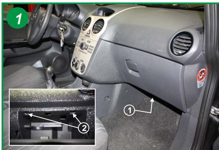
Le filtre d'habitacle est situé à l'intérieur du véhicule, coté passager derrière et sous la boîte à gants (1). Ouvrir la boîte à gants et dévisser les 2 vis Torx (T20)(2) (voir encadré). Refermer la boîte à gants.
