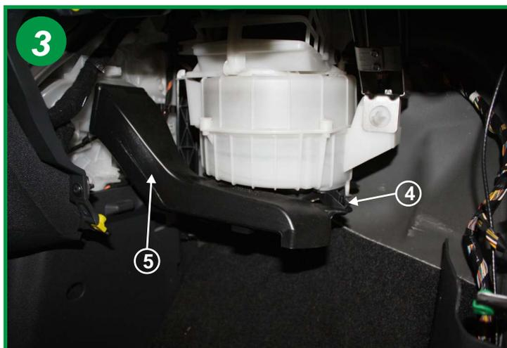
Retirer la goupille plastique (4) et dégager le conduit d'air (5).
