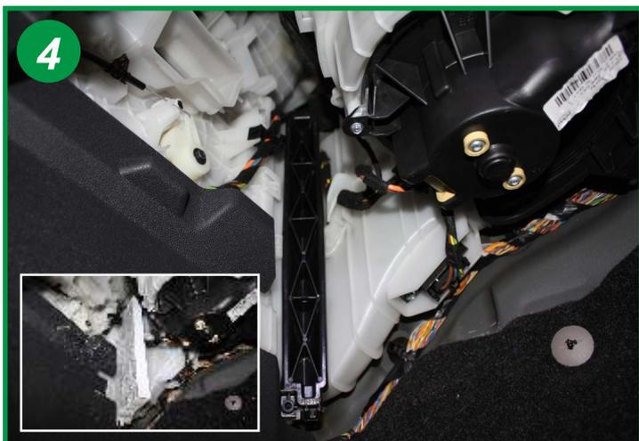
Ouvrir le boîtier filtrant en dégageant le couvercle (6) par le bas. Procéder au remplacement du filtre (voir encadré). Le remontage s'effectue dans l'ordre inverse du démontage.
