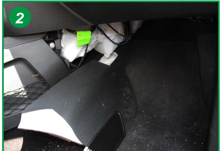
Dégrafer le flanc de la console centrale en tirant fortement et retirer ce carter dans sa totalité.
